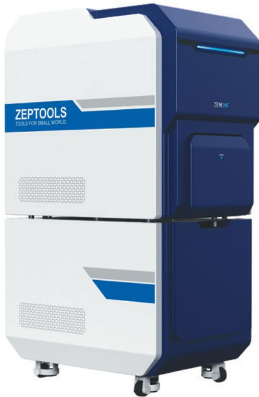
Настольный СЭМ ZEM Ultra обладает самым совершенным источником электронов – катодом Шоттки с полевой эмиссией, благодаря чему его разрешение достигает менее 2 нм.
